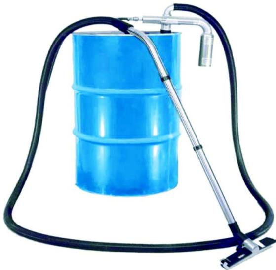
Kompakter ejektorgesteuerter Fassfüller für die Aufnahme und den Transport von Öl, Chemikalien, Wasser und sonstigen Flüssigkeiten Befestigung im Spundloch (R 2") eines geeigneten, leeren Fasses. Einfach an einen Druckluft- oder Saugschlauch anschließen und schon ist er einsatzbereit. Absaugstopp sobald das Fass gefüllt ist, dank eingebauten Schwimmerstopp. Der Ejektor lässt sich einfach auf vielen Fässern montieren. Fass nicht inklusive.
